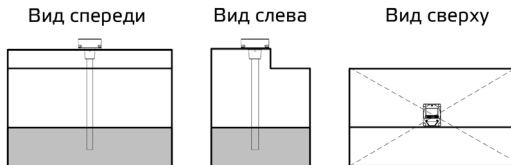
Рисунок 1. Выбор места установки датчика Omnicomm LLS-Ex 5
